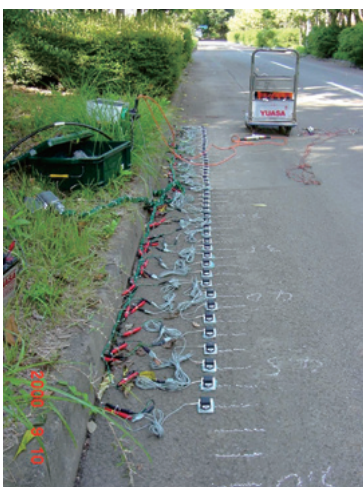
図-6 加速度センサを用いた高周波表面波探査実施例
