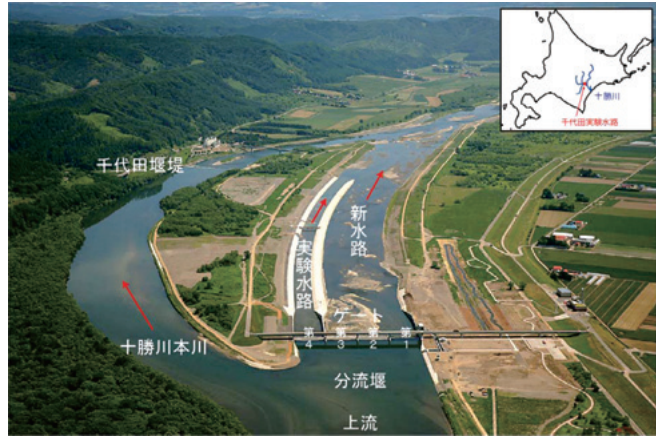
図-1 千代田新水路の施設配置
