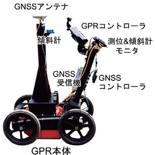
図-12 VRS-GNSS測位機能付きGPR試作機
