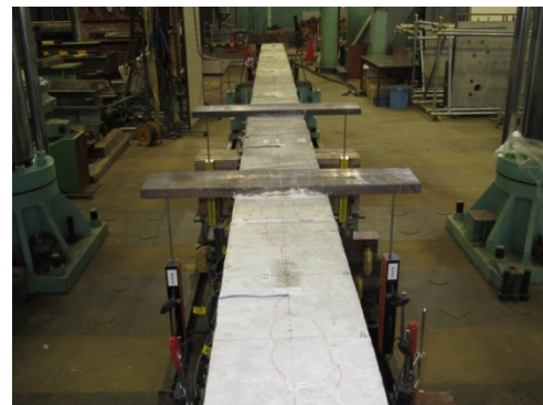
載荷点部変位計設置その 2
