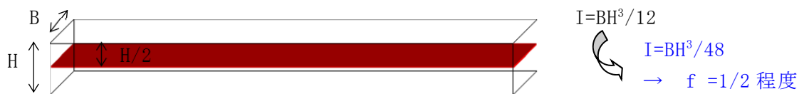
図 4-1 ひび割れが入ったことによる剛性低下の概念図
