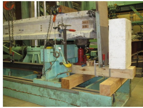
支点部変位計設置状況その 2
