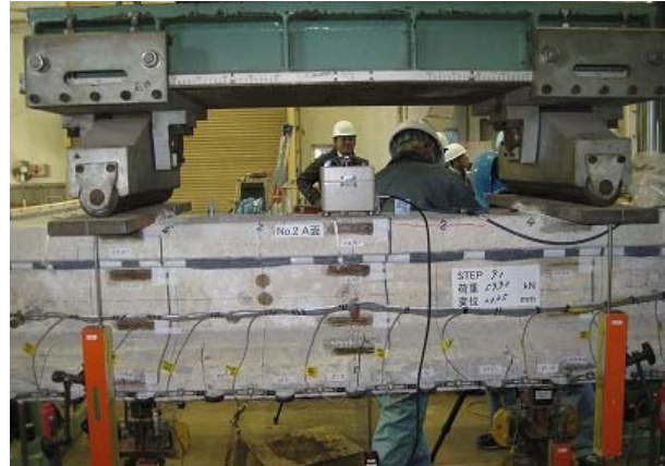
5 サイクルピーク時 (60kN) 側面
