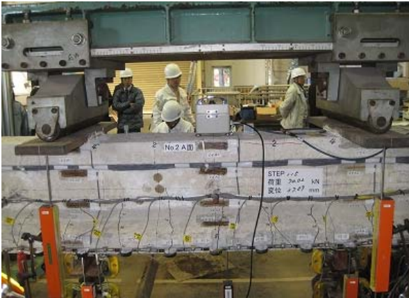
6 サイクルピーク時 (70kN) 側面
