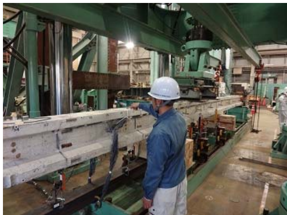
図4 プラスチックハンマーによる打撃
