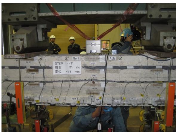
6 サイクルピーク時 (70kN) 側面
