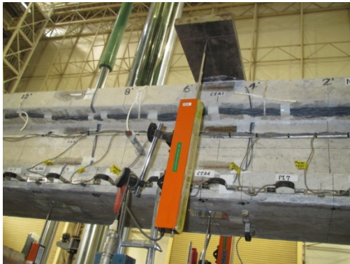
載荷点部変位計設置その 1
