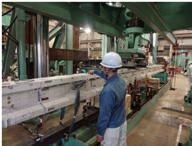
写真 4-1 プラスチックハンマーによる加振状況
