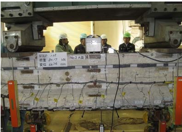
7 サイクルピーク時 (80kN) 側面
