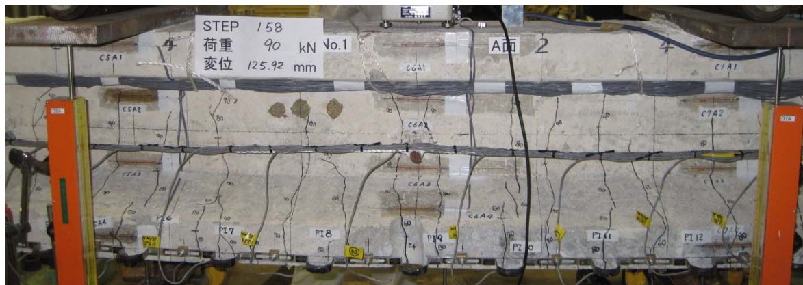
写真- 3.3 90kN 載荷時 桁側面ひび割れ状況
