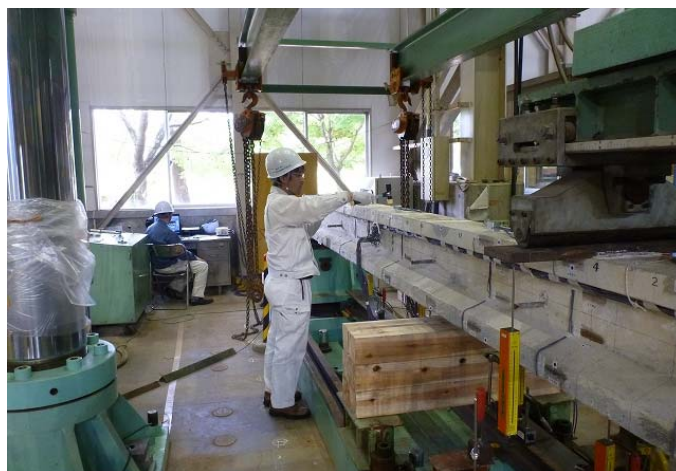
写真 4-3 ハンマーによる加振状況
