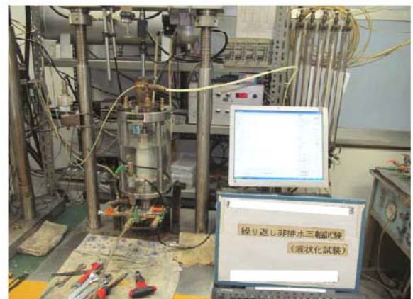
写真-3.3.3 繰返し三軸試験(液状化試験)
