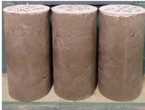
写真- 4.9 配合試験 (H26) 供試体外観 : W100kg/m 3
