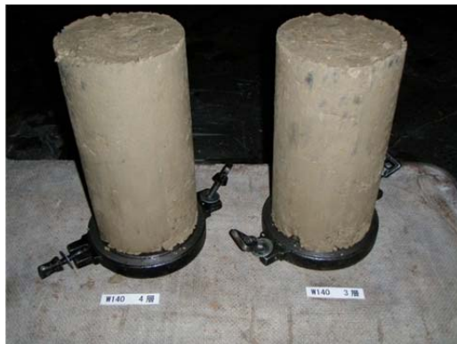
写真- 4.6 配合試験(H25) 供試体外観 : W140kg/m 3
