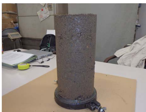
写真- 4.11 配合試験 (H27) 供試体外観 : W100kg/m 3
