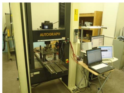
(b) 割裂引張試験
