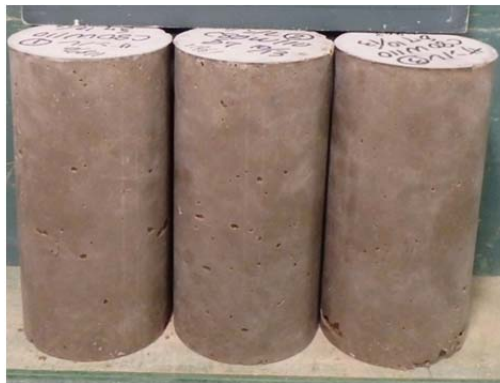
写真- 4.10 配合試験 (H26) 供試体外観 : W110kg/m 3
