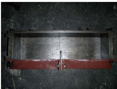
写真- 5.4 破壊エネルギー試験用供試体作製に用いた鋼製型枠
