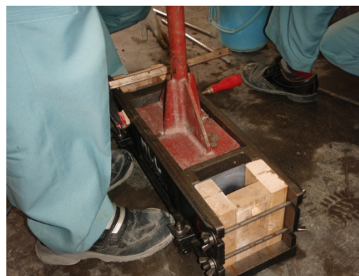
写真- 5.3 角柱供試体の作製
