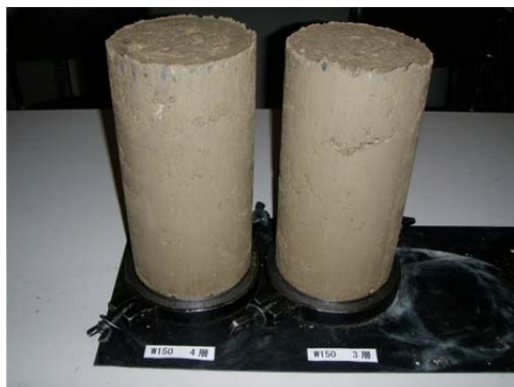
写真- 4.7 配合試験(H25) 供試体外観 : W150kg/m 3
