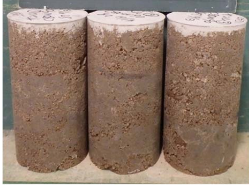
写真- 4.8 配合試験 (H26) 供試体外観 : W90kg/m 3
