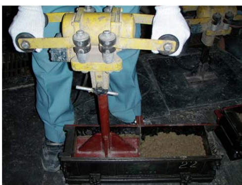
写真- 5.5 破壊エネルギー試験用供試体の作製
