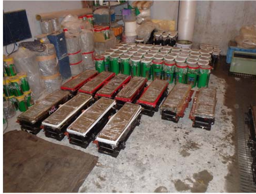
写真- 5.6 破壊エネルギー試験用供試体の養生状況
