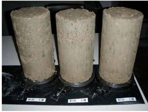
写真- 4.5 配合試験(H25) 供試体外観 : W130kg/m 3
