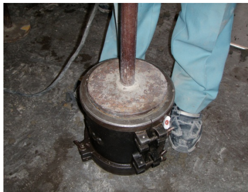
写真- 5.9 簡易一面せん断試験用供試体の作製
