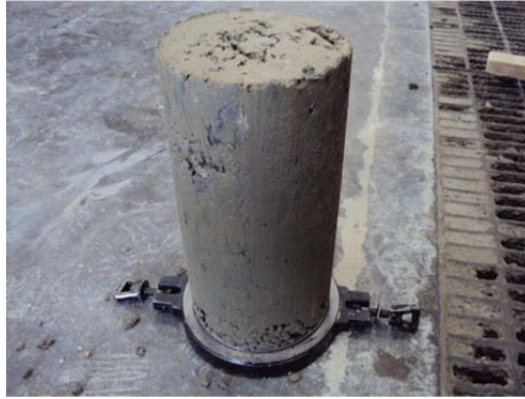
写真- 4.2 配合試験 (H24) 供試体外観 : W110kg/m 3
