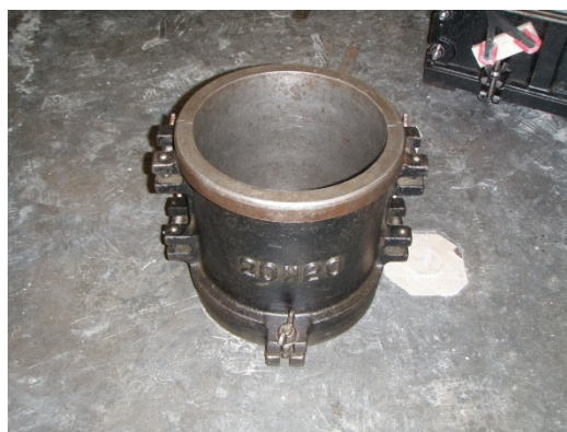
写真- 5.8 簡易一面せん断試験用供試体型枠
