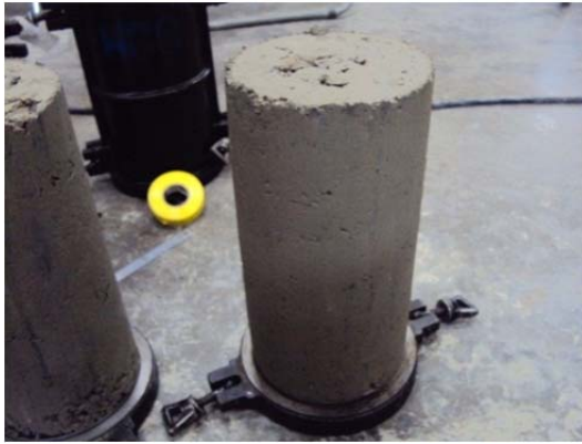
写真- 4.3 配合試験 (H24) 供試体外観 : W120kg/m 3
