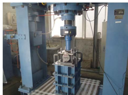
(b) 割裂引張試験
