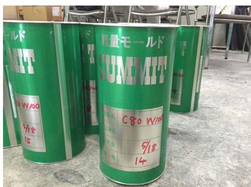
写真- 5.1 圧縮強度試験用供試体の作製に用いた軽量型枠
