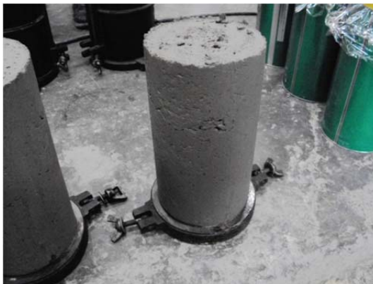
写真- 4.4 配合試験 (H24) 供試体外観 : W130kg/m 3
