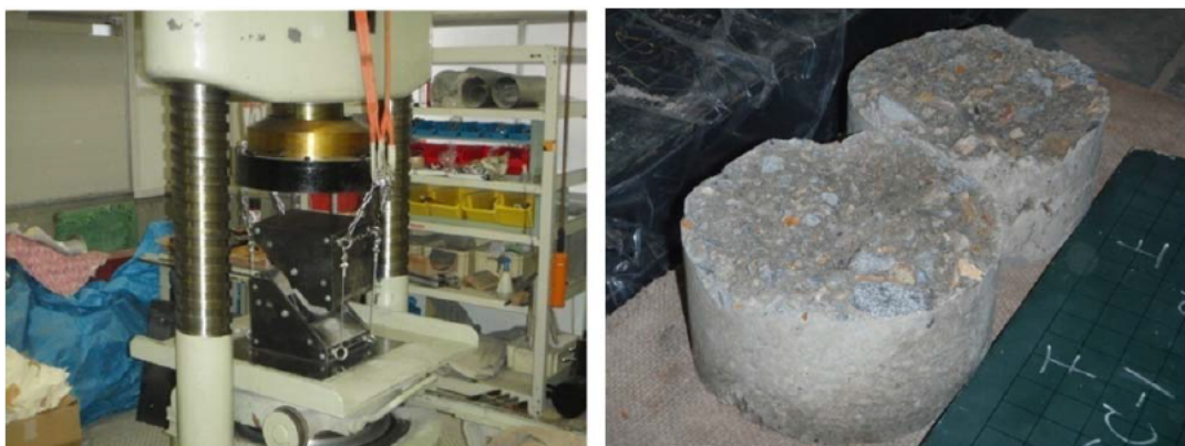
写真- 6.3 簡易一面せん断試験状況（左）と破壊後の供試体（右）
