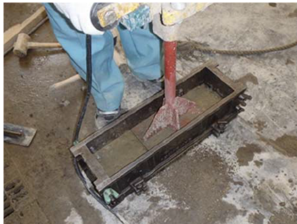
写真- 4.2 供試体作製（タンパ締固め）状況（破壊エネルギー試験用）
