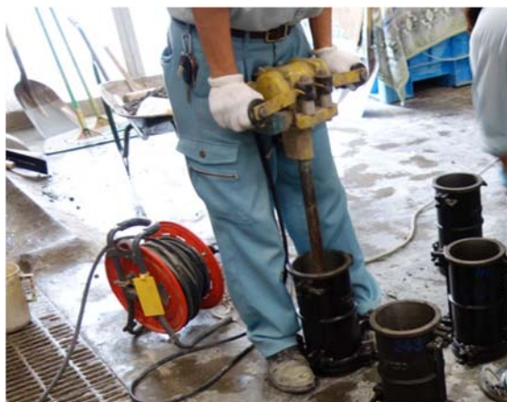
写真- 4.1 供試体作製（タンパ締固め）状況（B 配合）
