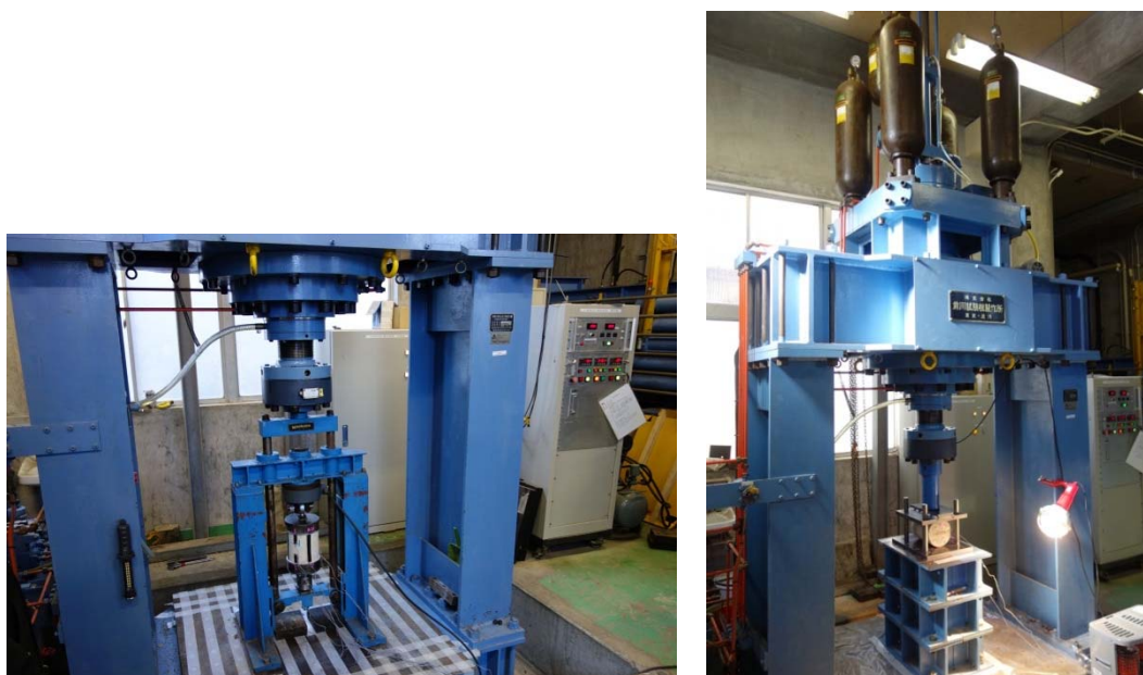
写真- 5.2 引張試験(急速荷重) 左: 直接引張試験 右: 割裂引張試験
