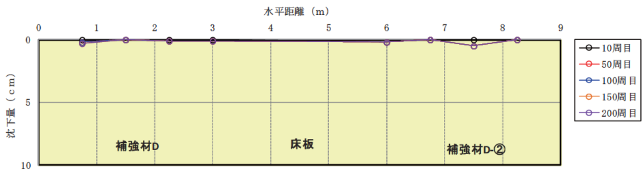
図-7.1.4-18 走行回数と地表面沈下量の関係：B側線
