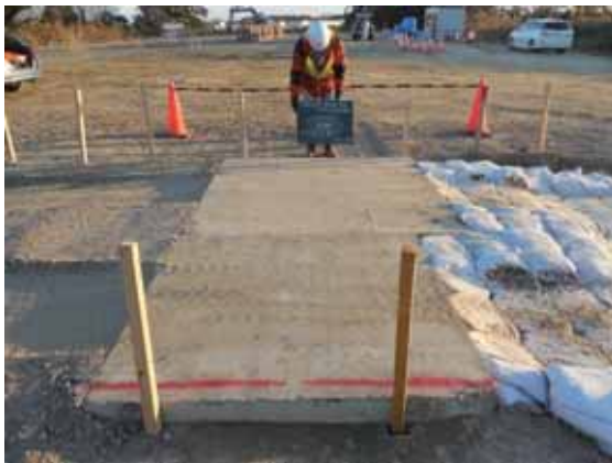
写真-7.1.4-4 ケース3の変状・損傷状況(200回走行)
