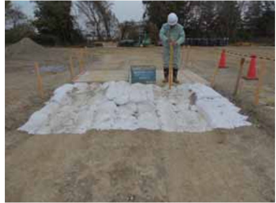
写真-7.1.3-14 土のう損傷状況：応急復旧段階(復旧盛土構築)の走行試験後
