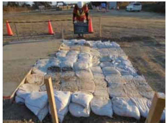
写真-7.1.4-4 ケース3の変状・損傷状況(200回走行)
