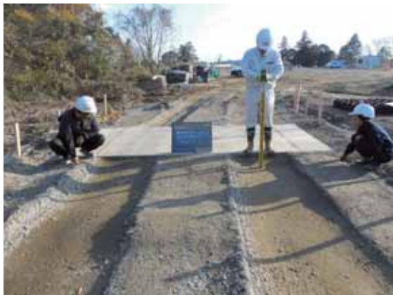
写真-7.1.3-16 ケース2 試験ヤードの轍掘れ状況：応急復旧段階の走行試験後
