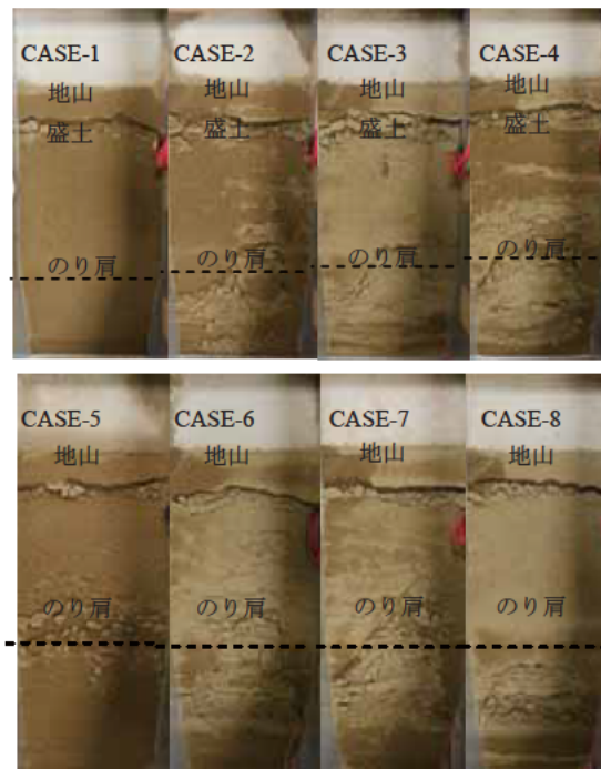
写真-3.6-4 天端の状況 (500gal 加振後)
