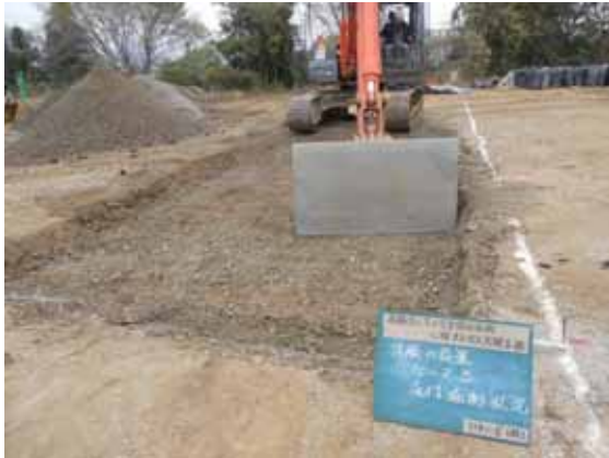
写真-7.1.3-11 路面段差を模倣した地盤の造成と床版の設置状況
