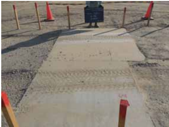
写真-7.1.4-5 ケース3の変状・損傷状況(200回走行)
