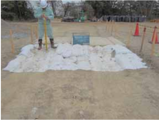
写真-7.1.3-14 土のう損傷状況：応急復旧段階(復旧盛土構築)の走行試験後
