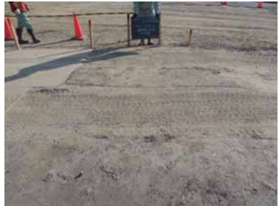
写真-7.1.4-5 ケース3の変状・損傷状況(200回走行)
