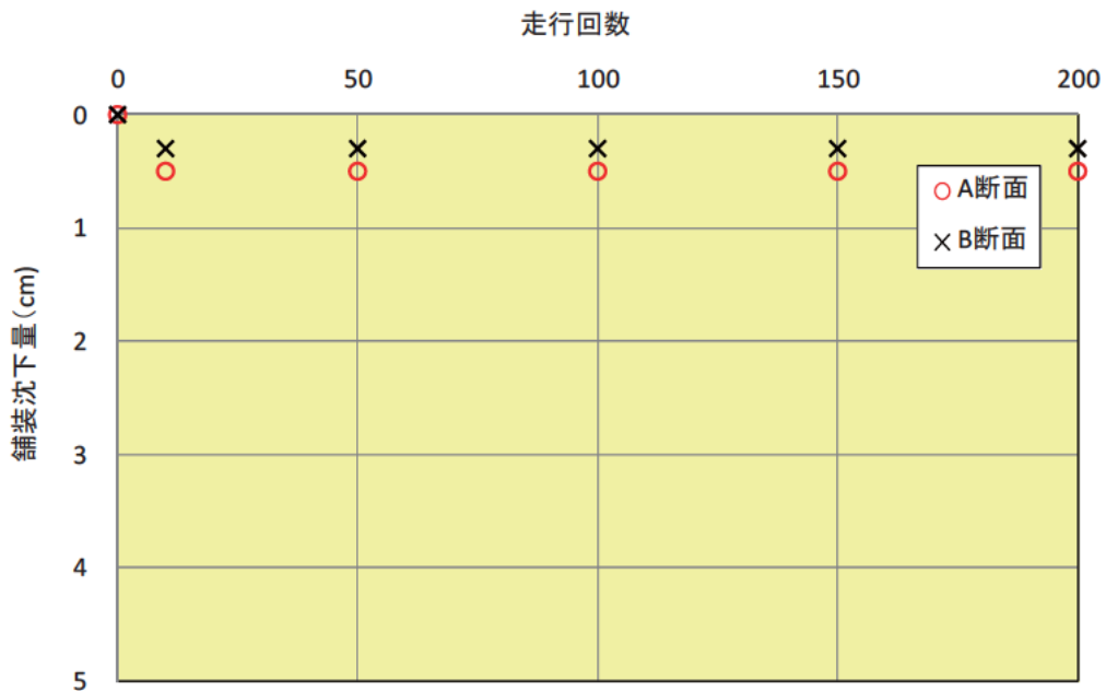
図-4.3.2-19 走行回数と舗装面沈下量の関係(舗装面：④と②計測位置)
