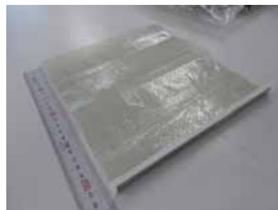
写真-3.6-2 壁面材と補強材
