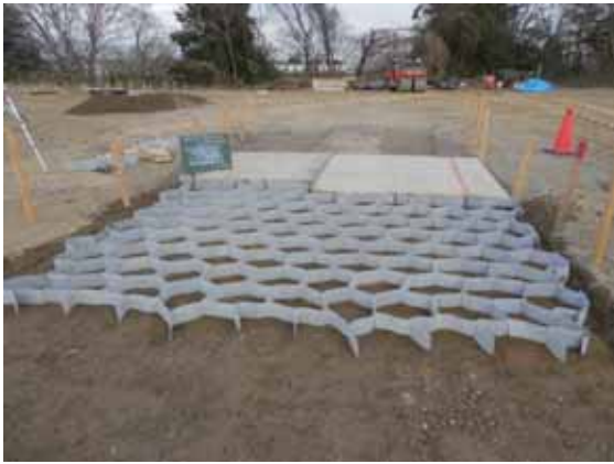
写真-7.1.3-14 土のう損傷状況：応急復旧段階(復旧盛土構築)の走行試験後
