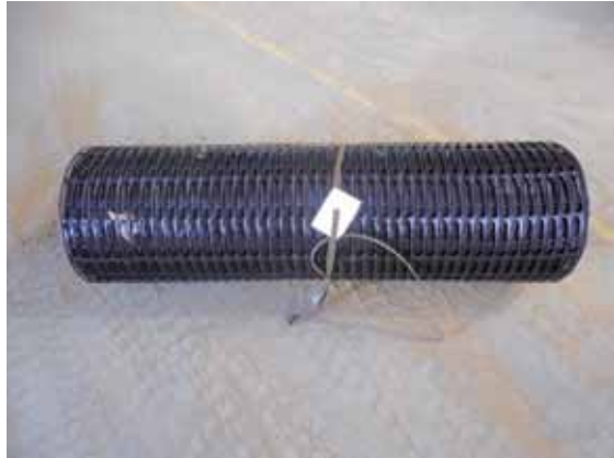
写真-4.2.1-12 壁面補強材
