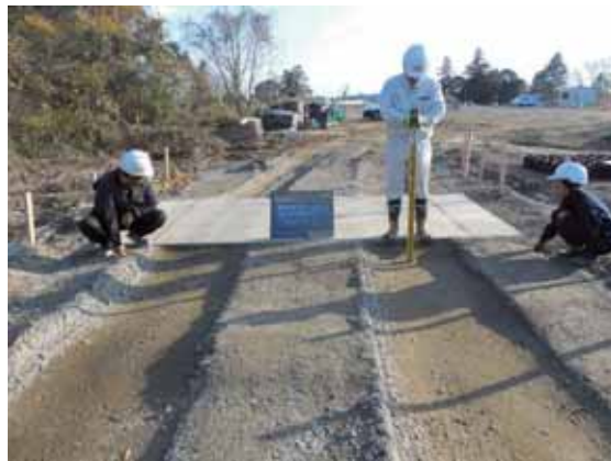
写真-7.1.3-16 ケース2 試験ヤードの轍掘れ状況：応急復旧段階の走行試験後
