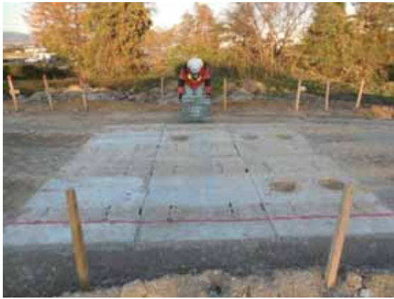
写真-7.1.4-1 ケース1の変状・損傷状況(200回走行)
