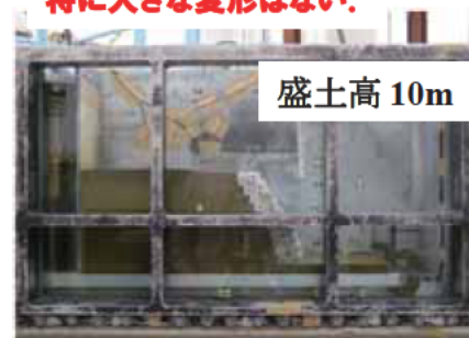
写真-3.3-2: 実験後の盛土崩壊の状況 (盛土高 10m の場合)
