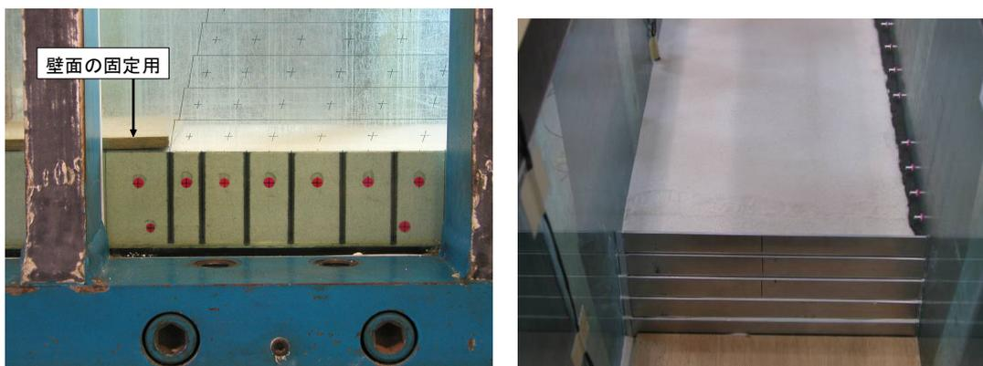
図 2-30 壁面の設置および背後地盤の作製
