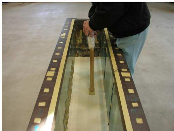
図 2-27 基礎地盤の作製
