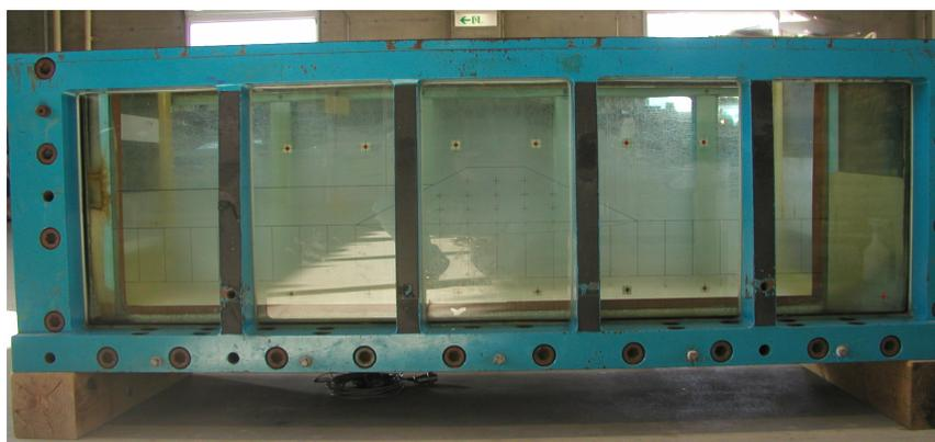
図 2-2 動的大型土槽
