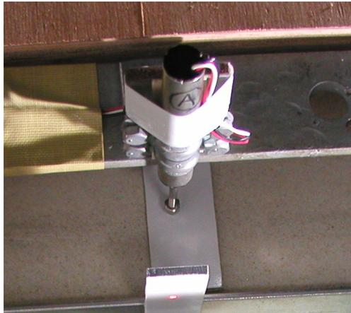
図 2-39 天端沈下計測用ポテンショメータ
