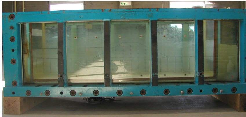
図 2-1 動的大型土槽
