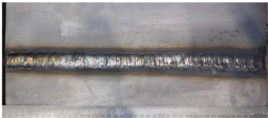
(b) リーン系二相ステンレス鋼溶接試験体 立向姿勢
