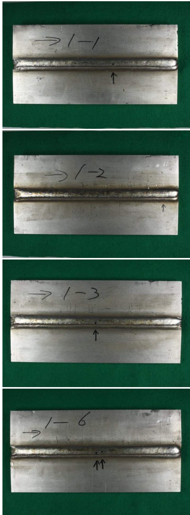
写真 3.2.1 SUS821L1 追加設置分溶接材外観
