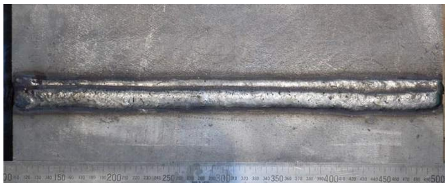
(a) リーン系二相ステンレス鋼溶接試験体 下向姿勢
