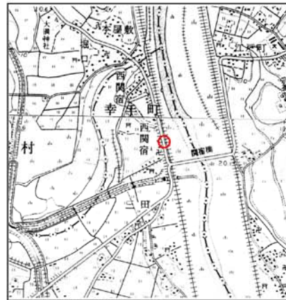
⑥1972年(昭和47年)修正 1/25000 調査地の堤防は、拡幅されて道路も整備されている。
