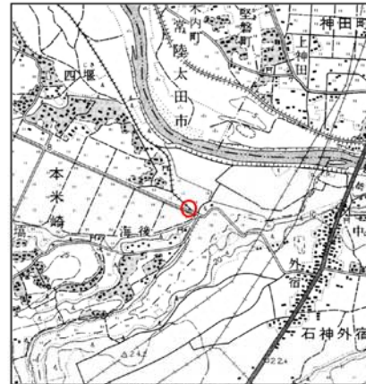
④1968年(昭和43年)改測 1/25000 堤防として整備される。堤防の川裏に道路が建設される。
