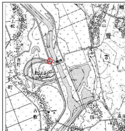
⑥1977年(昭和52年)改測 1/25000 下郷橋より上流部分では堤防天端が広がっている。
