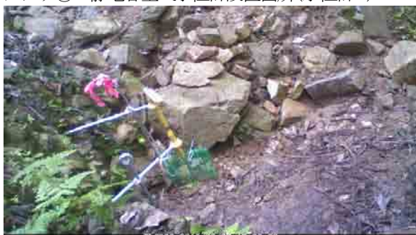
カメラ⑪ 静電容量式水位計設置箇所(水位計2)
