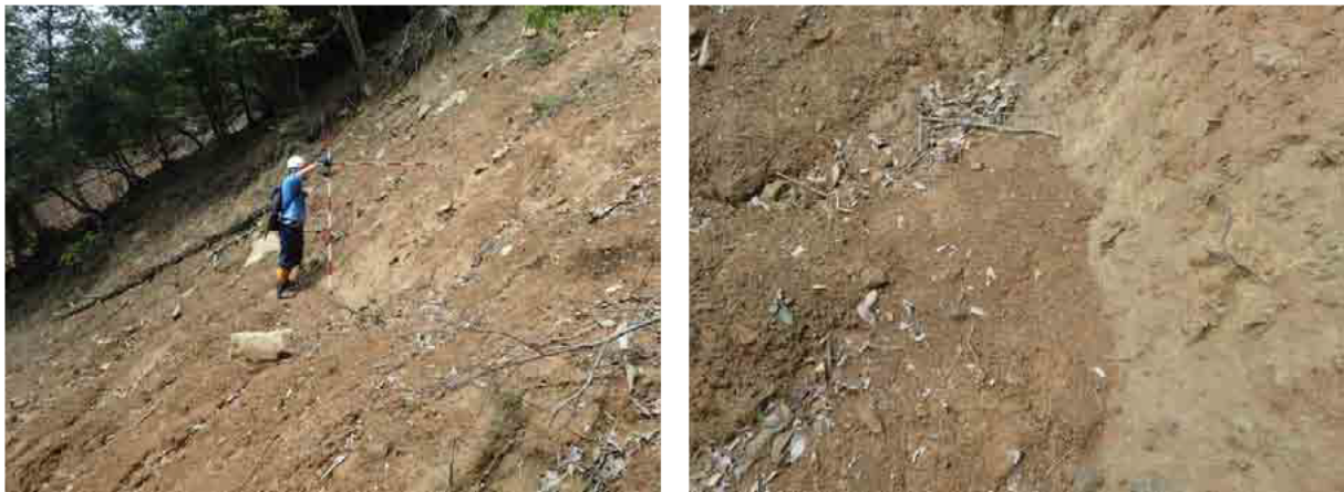
写真 2.3.2 崩壊斜面上にある細粒分の堆積土砂 (①地点)
