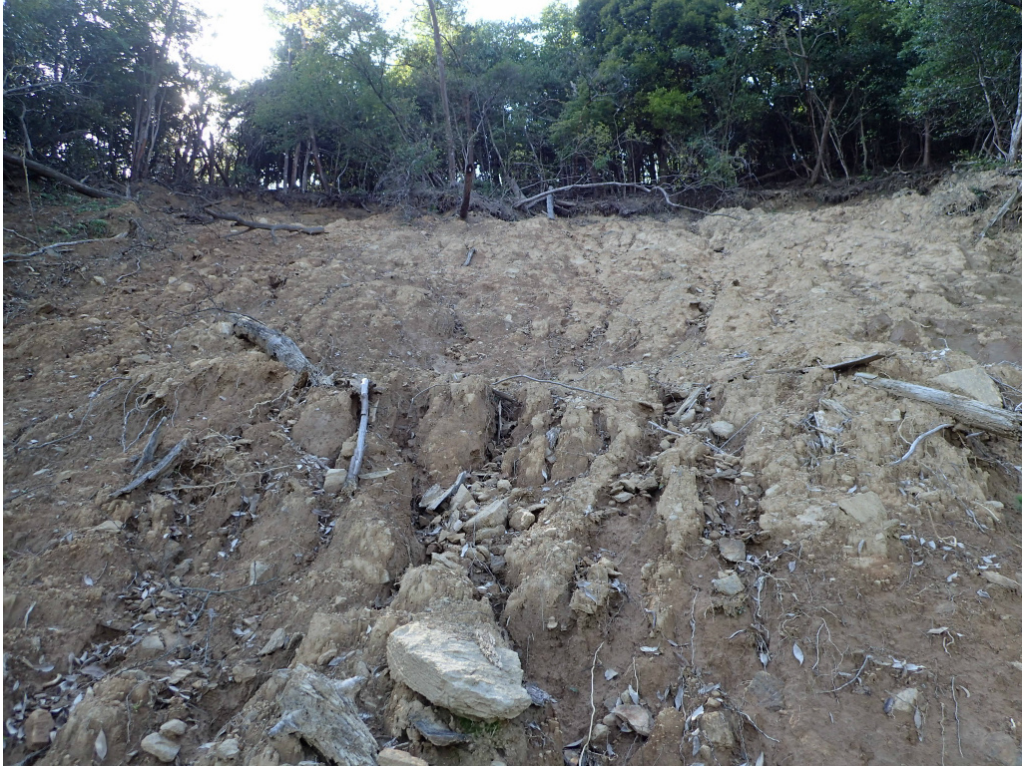
写真 2.3.3 崩壊斜面上にある粒径5cm程度以上の堆積土砂（①地点）
