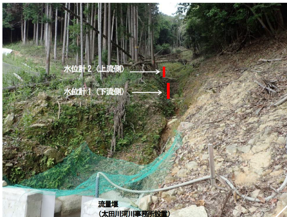
写真 3.3.5 静電容量式水位計の設置状況 (全景)
