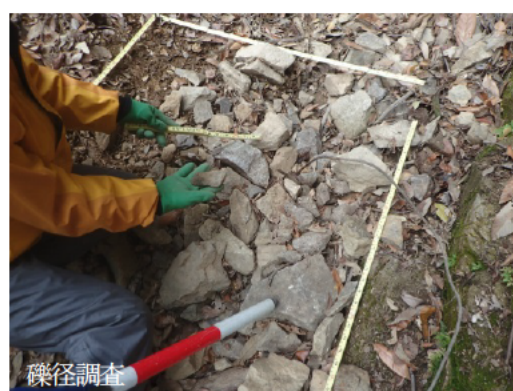
写真 2.3.5 現地での土砂採取および礫径調査の状況
