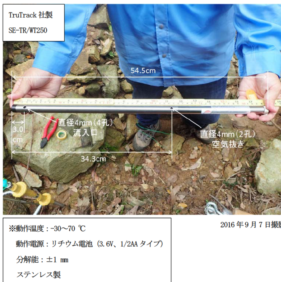
写真 3.3.1 静電容量式水位計
