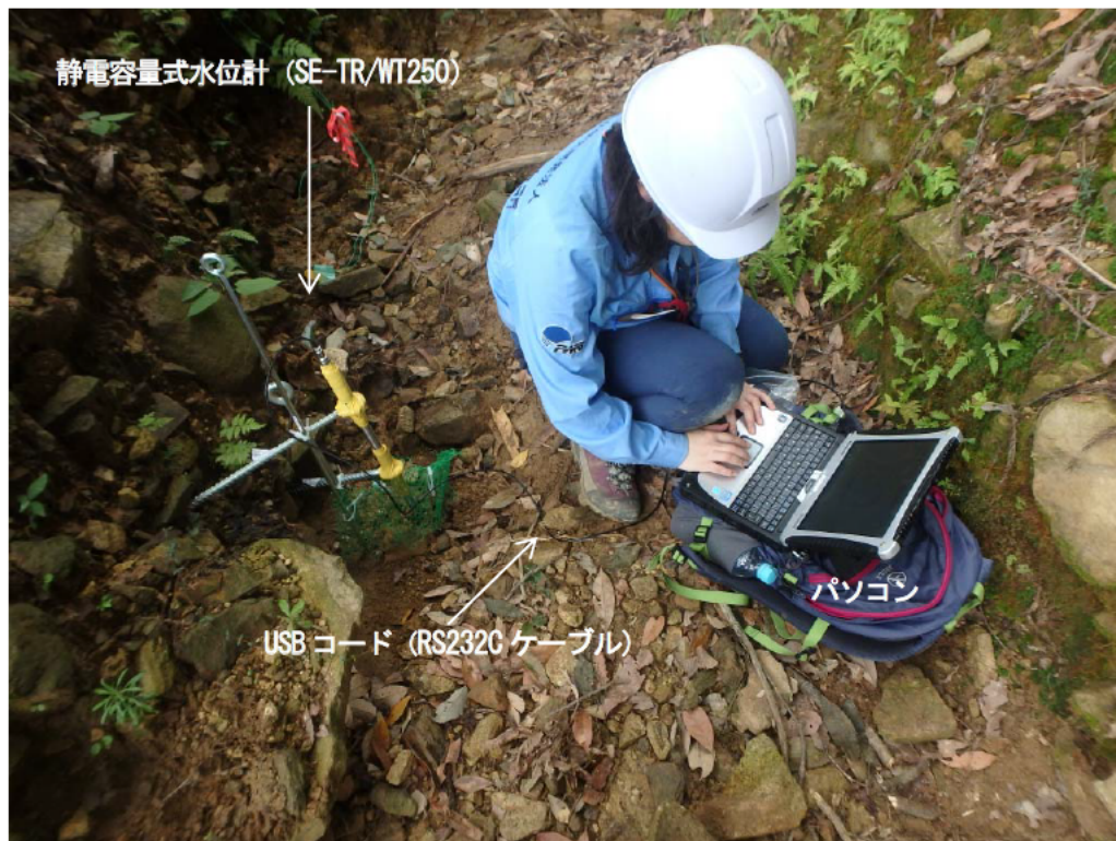
写真 3.3.3 水位計とパソコンの接続状況
