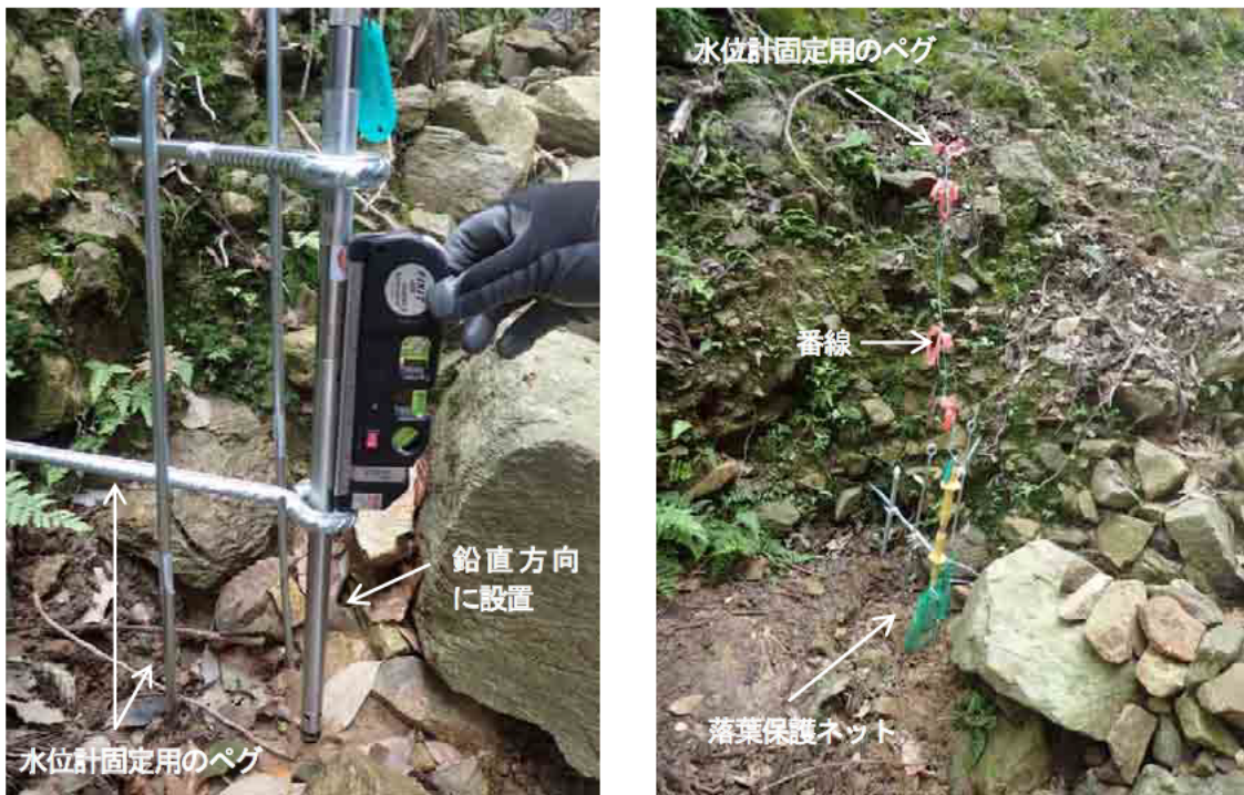
写真 3.3.8 水位計の設置状況の確認と落葉保護ネット
