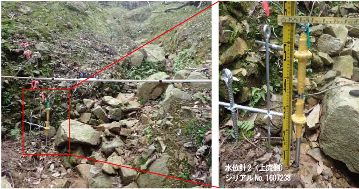
写真 3.3.7 上流側の水位計2の設置状況
