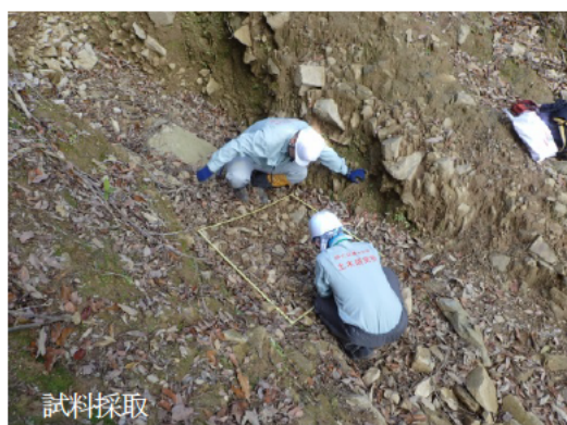
写真 2.3.5 現地での土砂採取および礫径調査の状況
