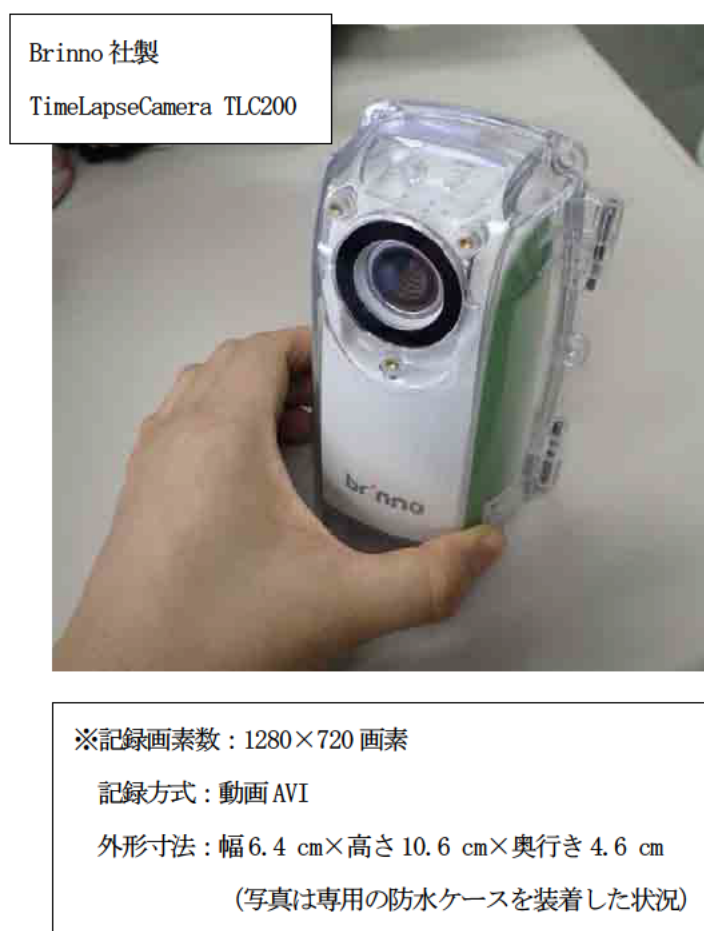
写真 3.2.1 現地観測に用いたインターバルカメラ（防水ケース装着）
