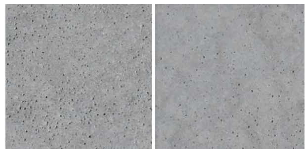
油泡多い 輝度の標準偏差 14 油泡少ない 輝度の標準偏差 9
