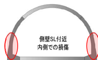
図-3 断面の斜めひび割れ発生位置
