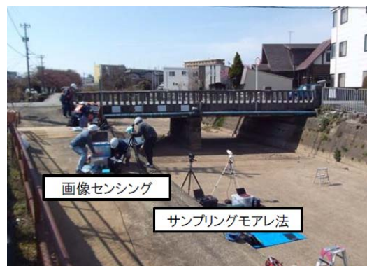
写真2 現場適用状況の例（画像センシング、サンプリングモアレ）
