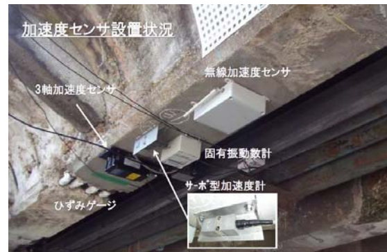
写真3 現場適用状況の例 (加速度センサ、固有振動数計)
