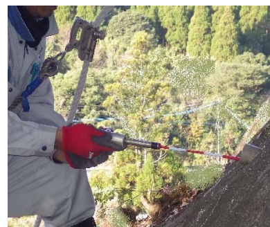
写真1 土壌硬度計測状況
