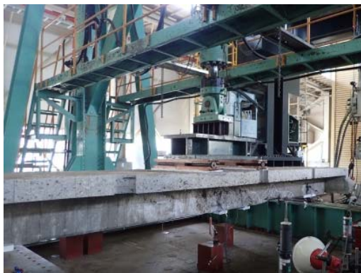
図8 繰返し载荷試験状況
