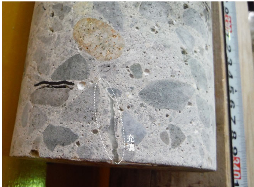
写真-3.4.5 ひび割れ補修材の注入による断面欠損の回復
