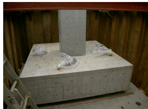
(供試体設置完了) ※荷重未上載
