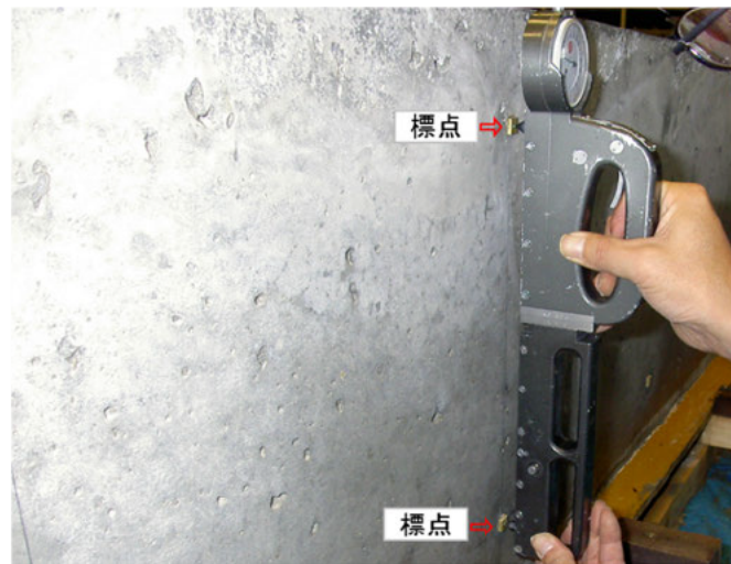
写真-3.3.2 コンタクトゲージによる表面ひずみの測定状況
