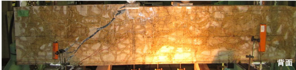
写真-3.4.3 破壊形態
