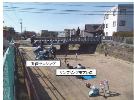
写真-3.1.3 遠望から変位等を検出するモニタリング技術
