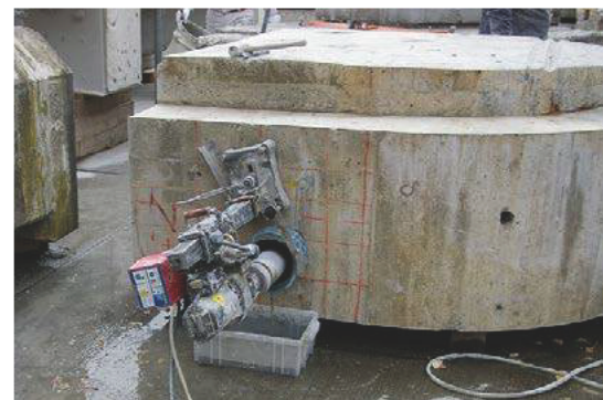
写真-3.3.8 材料強度試験及び塩分含有量測定を実施するためのコアの採取
