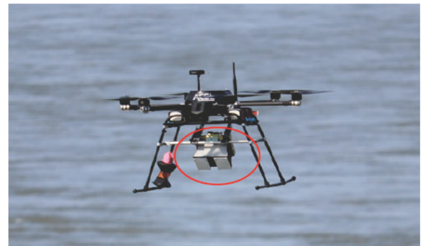
写真－5 ドローンに搭載した電波式流速計
