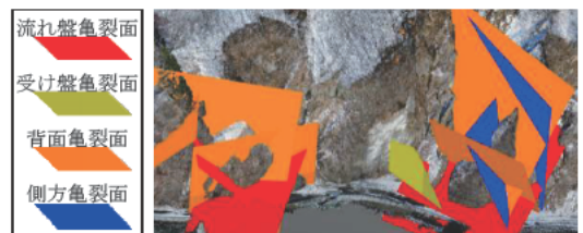
図-7 開口亀裂面の三次元モデル化 11)
