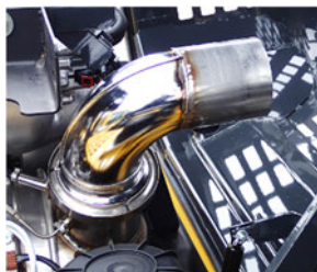
図-2.6 排気流量測定のために製作した接続管の例.
