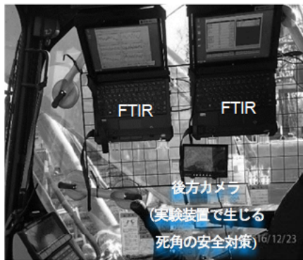
図-5 油圧ショベルに搭載した測定装置。 (転載元の図の一部をマスクングしている。)
