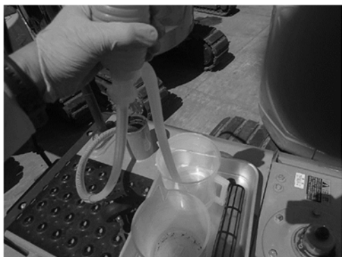
図 F.2.1 燃料の抜き取り
