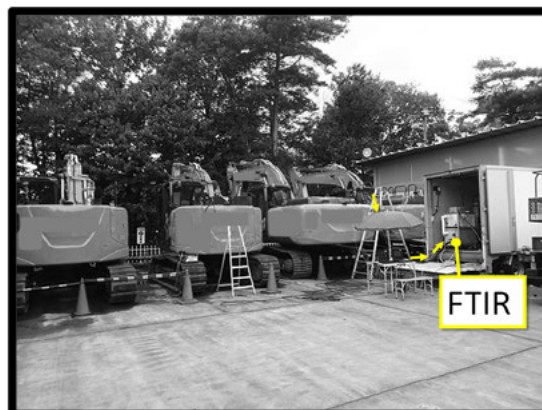
図-2.4 2018年度の測定. 同一の敷地内で油圧ショベル4台を測定した。排出ガスは加熱導管で排気管からサンプルした。傘は日よけ。
