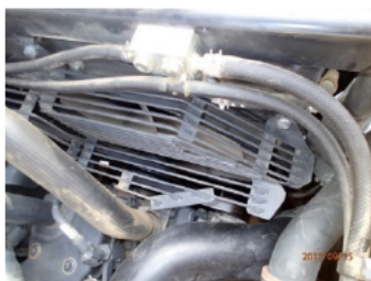
図-2.10 建設機械のエンジンルームの例。回転部分への接触を防止するガードが付けられている。
