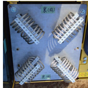
図-A.2.2 測定機器の写真。(1) 排気流量計用の直管とエンジンの排気管を接続するため製作した接続管。(2) FTIR の防振対策として設置したワイヤーロープ防振器。
