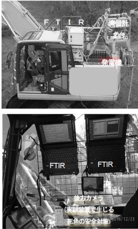
図-5 油圧ショベルに搭載した測定装置。 (転載元の図の一部をマスクしている。)
