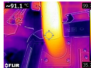
図 9.2 排気管の赤外線画像.
