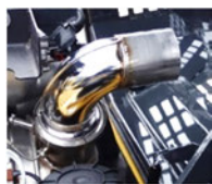
図-15 排気流量測定のために製作した接続管の例
