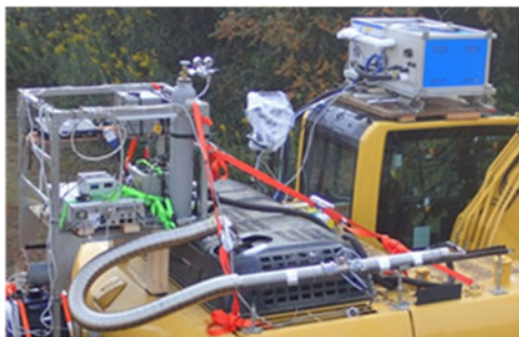
図-2 油圧ショベルに搭載した測定装置.
