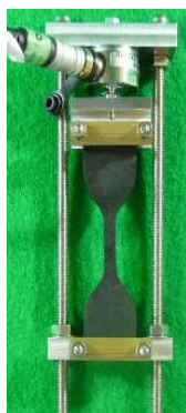
写真-4 試験片のジグへの取付状況とオゾン試験機への取付状況
