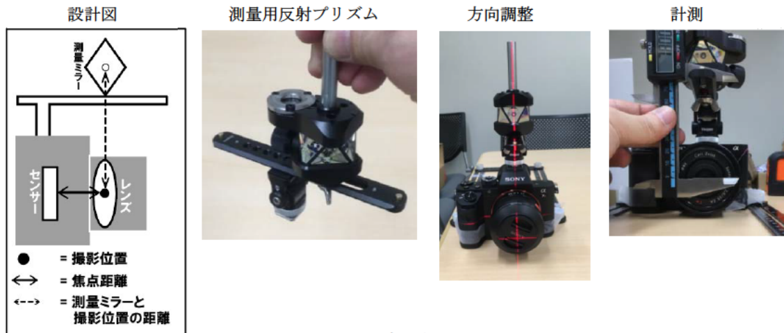
図-2 測量用反射プリズム付きカメラ作成方法
