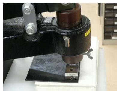
写真-3 試験片打ち抜き加工状況
