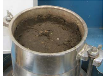
写 1 CBR 試験の供試体作製状況
