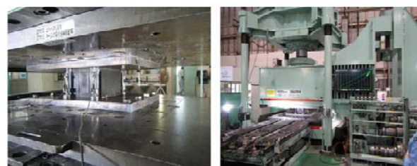
写真-3 鉛直変形特性試験の状況
