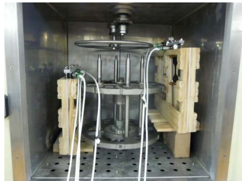
写真-4 試験片のジグへの取付状況とオゾン試験機への取付状況
