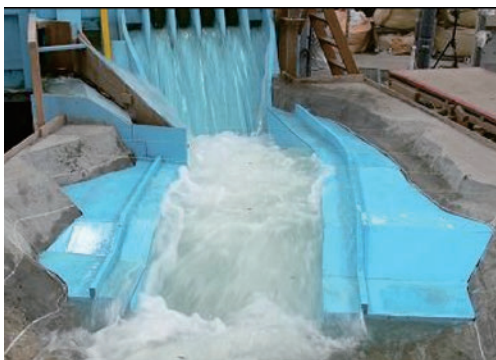
図-5 長安ロダム改造水理模型実験
