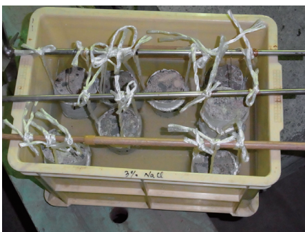
図-2.11 塩水浸漬試験の状況
