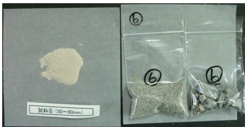
図-2.15 コア No.1 の F 塩分析用の試料（左）と除去した骨材（右） （深さ 50～60 mm の試料の例）
