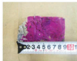
中性化深さ試験
