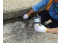
舗装打ち継ぎ部(カウント値669) 地覆端部(カウント値614) 健全部(カウント値139)
