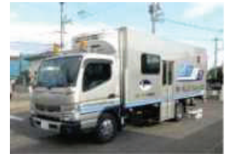
※マイクロ波による劣化部調査 NETIS新技術情報提供システム 「スケルカ」より
