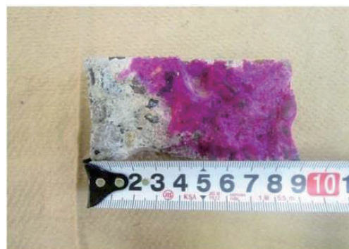
写真-2 中性化深さ試験
