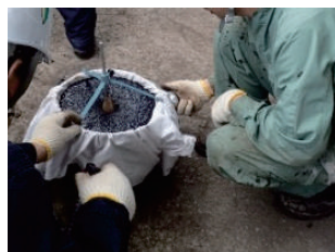
写真-6 温度・流動性測定状況
