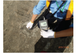
舗装打ち継ぎ部(カウント値669) 地覆端部(カウント値614) 健全部(カウント値139)
