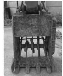
写真1 バックホウ取り付け型攪拌バケット
