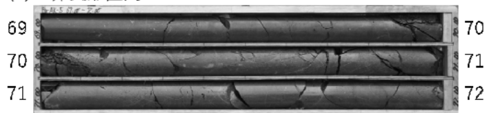
図-2 破碎度区分 Cr1a' のコアの破碎状況 (写真横の数字は深度)
