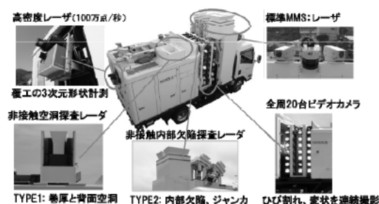
図-1 走行型計測システム (MIMM-R) 概要
