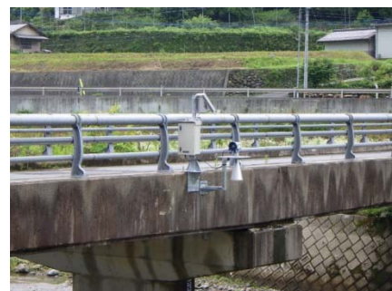
危機管理型水位計（洪水時の水位観測に特化した低コスト水位計）
