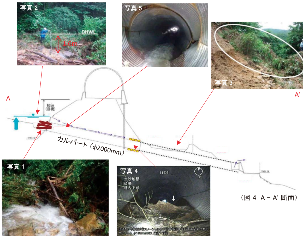
図5 カルバート及び流入口の被害状況
