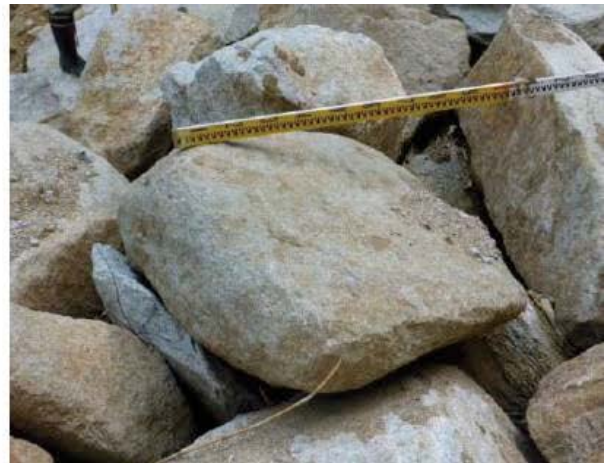
図5 土石流により運搬された礫及び土砂の状況 a)
