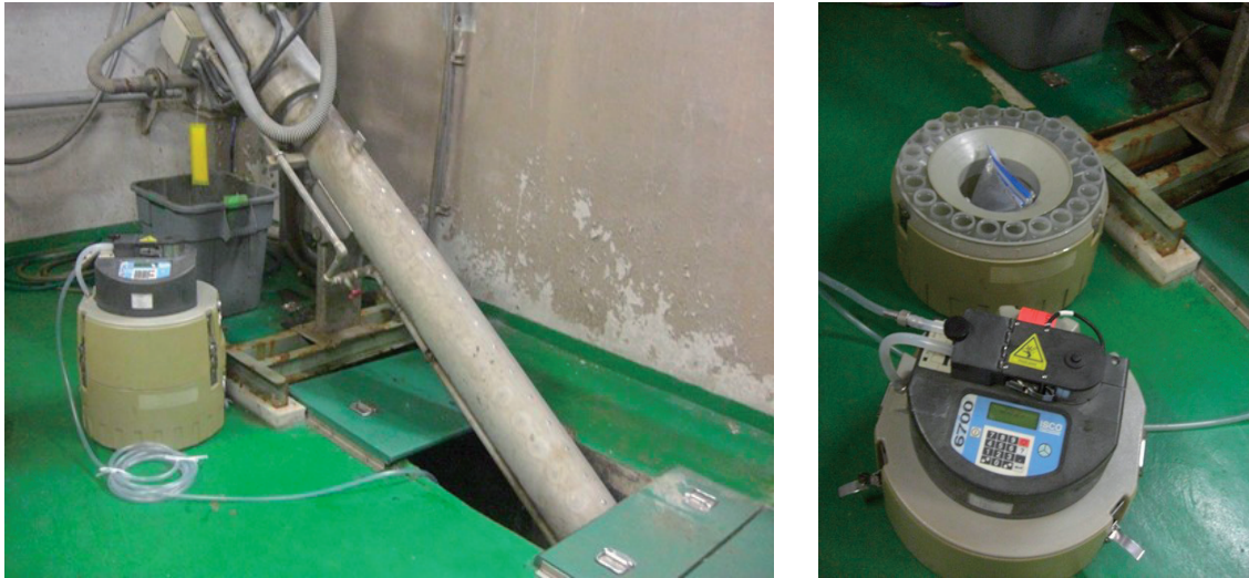
写真-2 自動採水器による B 処理場 24 時間採水の様子
