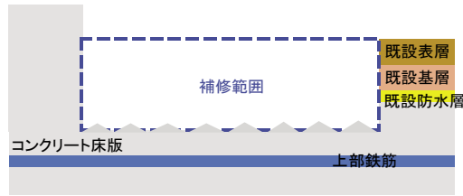
図-2.8 床版（鉄筋上部まで）まで打換える場合の模式図
