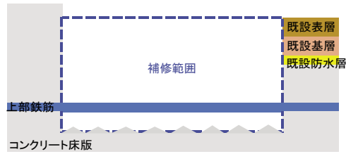
図-2.9 床版（鉄筋下部まで）まで打換える場合の模式図
