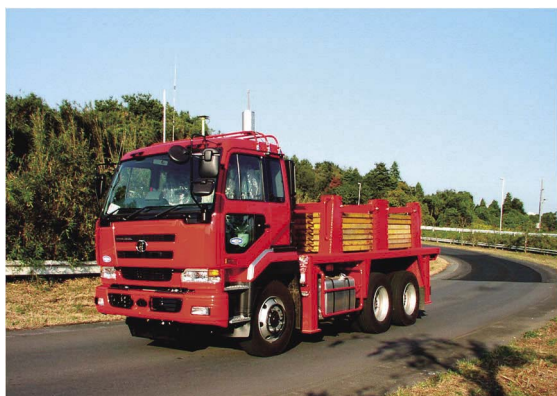
写真- 6.8 荷重車による促進载荷状況
