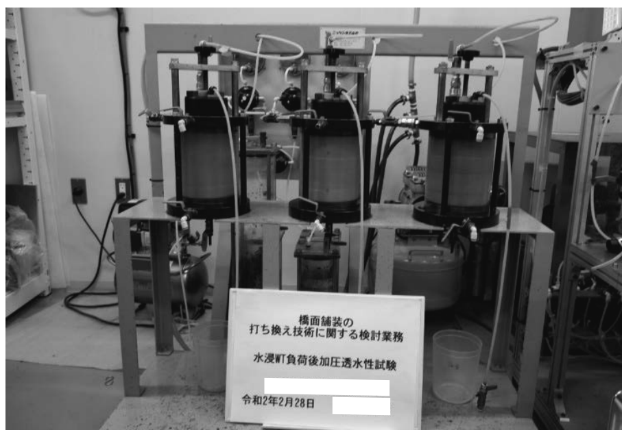
写真- 5.11 加圧透水試験状況
