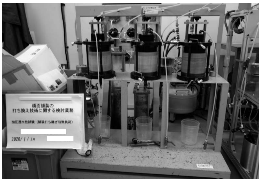
写真-5.6 加圧透水試験状況
