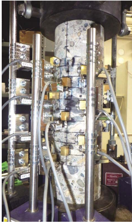
図-4.14 深さごとの静弾性係数の測定状況と測定方法
