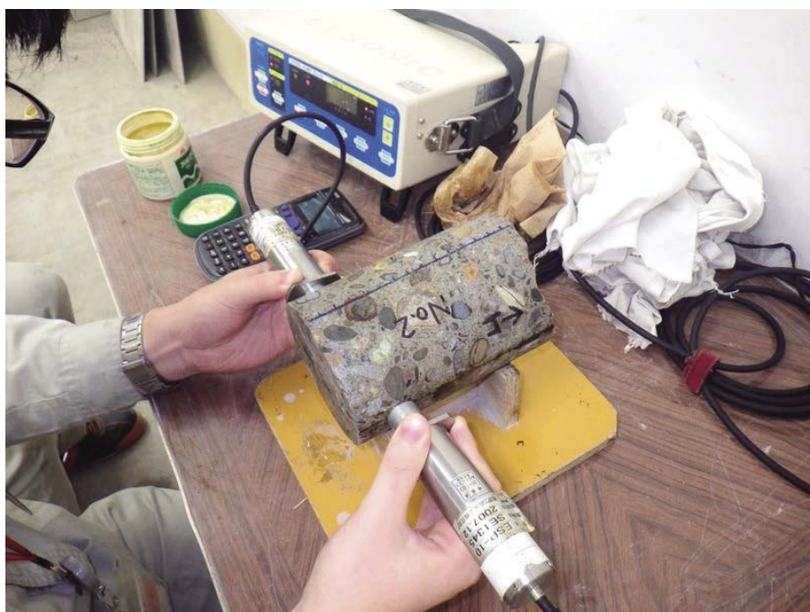
図-4.13 深さごとの超音波伝播速度測定の測定状況
