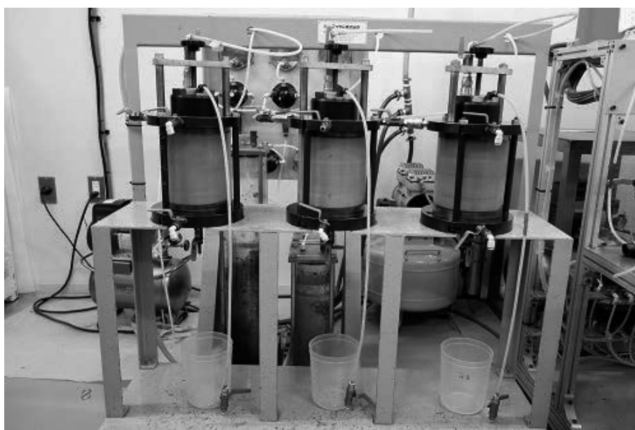
写真- 5.1 加圧透水試験状況
