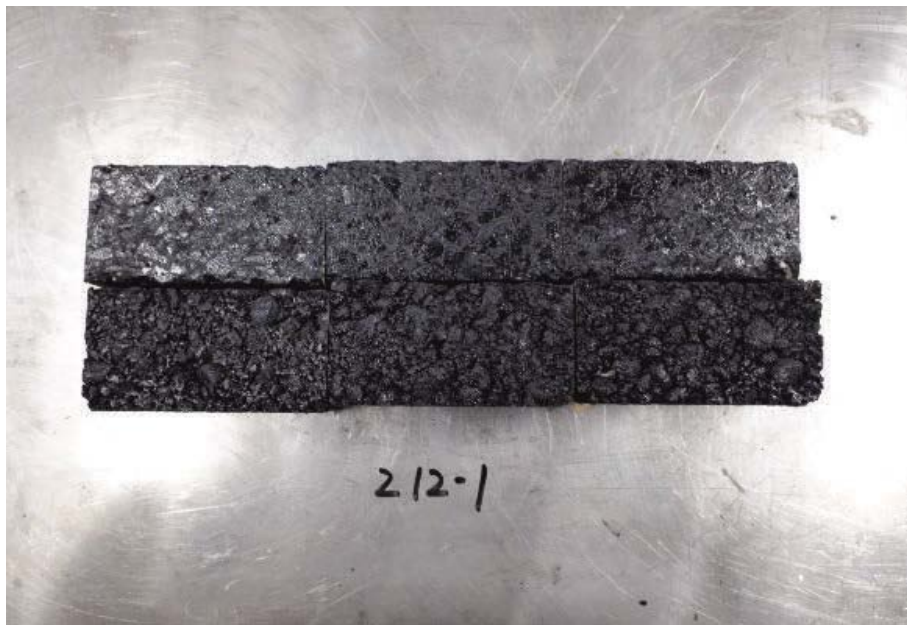
写真-5.7 未対策（負荷後）
