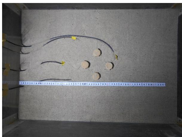
(c) 間隙水圧計の設置
