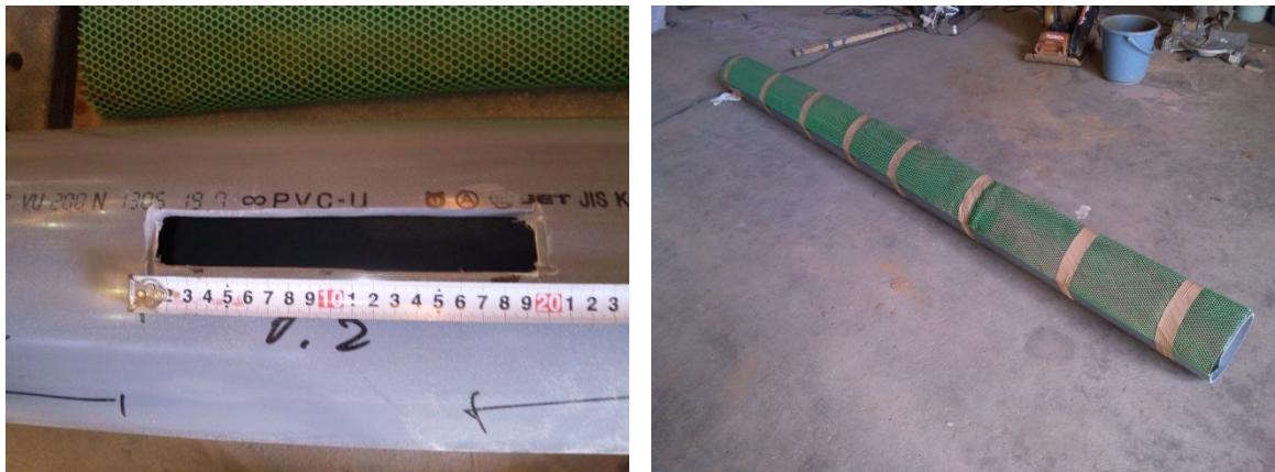
(a) 給水塩ビ管スリット加工部 (b) 吸出し防止材を巻き付けた給水塩ビ管
