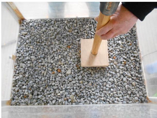
(a) 碎石層の突き固め
