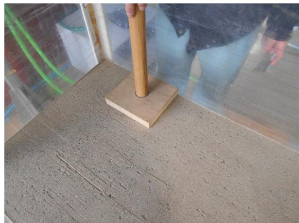
(b) 透水層の突き固め
